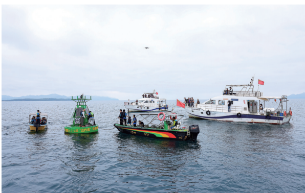
科研团队实施“合作者号”浮标和传感器的例行维护
